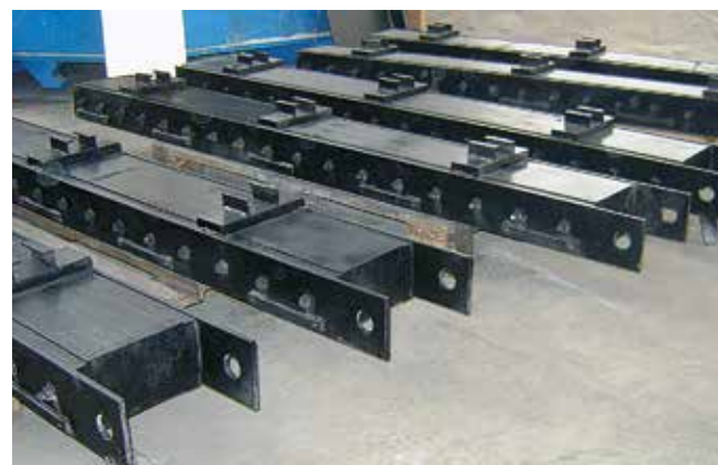
Magnetjoch in luft- oder wassergekühlter Ausführung
