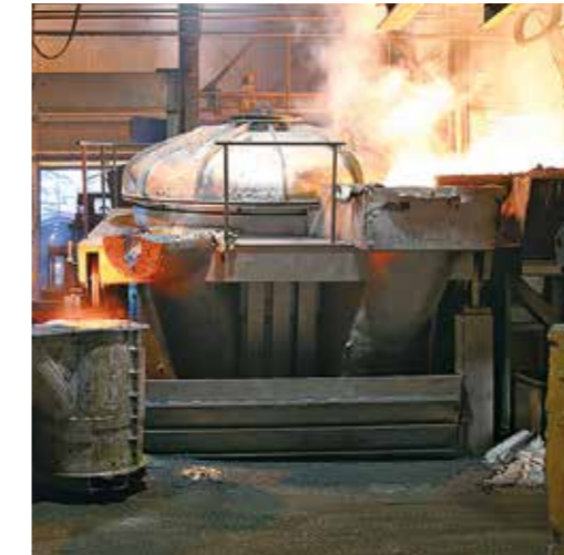
65 und 85 t Vorherd, Kippen über Hydraulikzylinder
