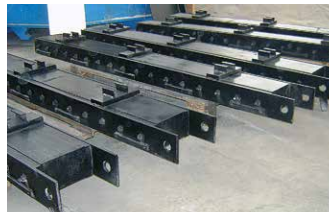
Culasse magnétique refroidie par air ou par eau
