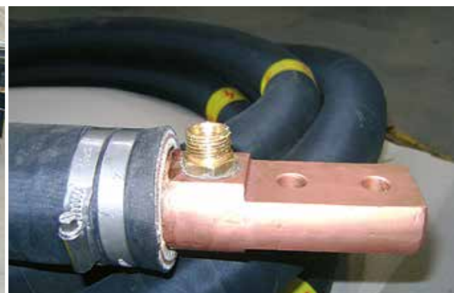
Câble électrique refroidi par air ou par eau
