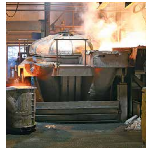
Avant-creuset de 65 et 85 t, basculement via vérin hydraulique
