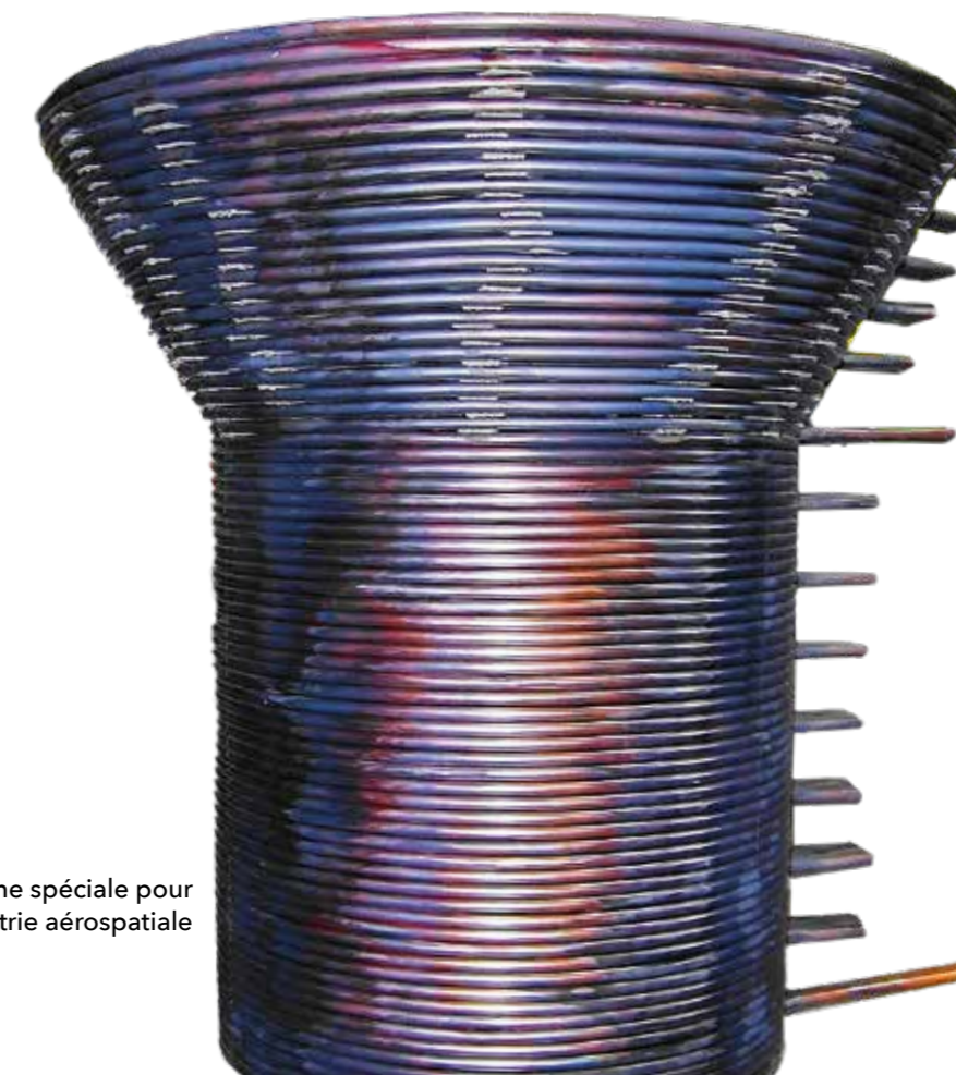
Inducteur de forge pour chauffage de blocs
