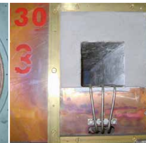
Inducteur de forge pour chauffage de blocs
